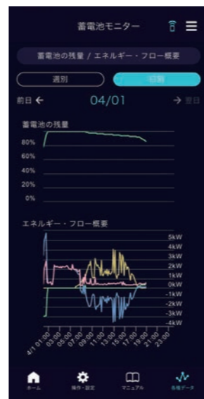
蓄電システムの残量/ エネルギーフロー概要
